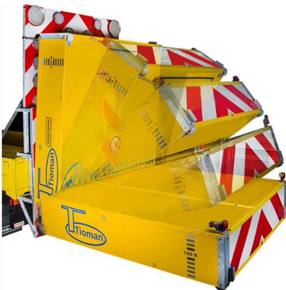
1. TMA. Graficzna ilustracja podnoszenia/opuszczenia poduszki zderzeniowej.
